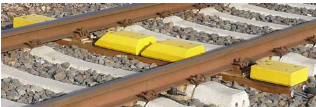
Рис. 1. Прилад виявлення нагрітих букс ПВНАБ (ДИСК-Б)
