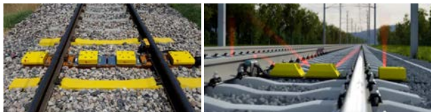
Рис. 5. Система PEGASUS Hot Box Detection ITSS (Іспанія)
